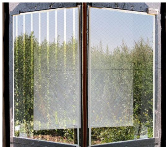
Eine in Entwicklung stehende Markierung (Fraunhofer ISE) mit transparenten Streifen auf Position 1 erwies sich als hoch wirksam (links Prüf-, rechts Referenzscheibe).
