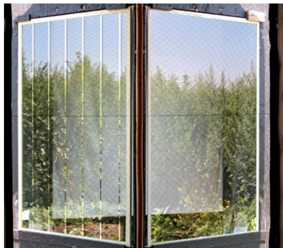
Arnold Glas Ornifix® design lines 5/95: hoch wirksame Metallmarkierung mit klassischem Streifenmuster (links Prüf-, rechts Referenzscheibe).
