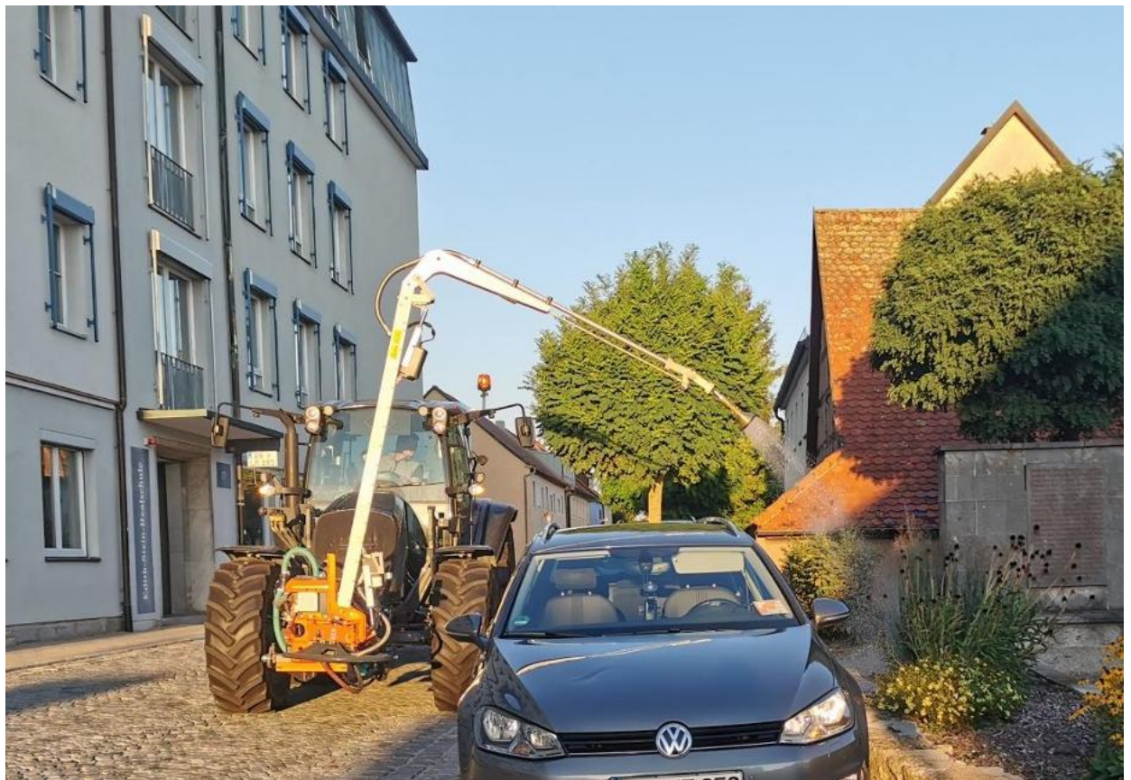
Abbildung 43 Schillingsfürst: Selbst entwickelter Gießarm für schwer erreichbares Stadtgrün. Foto: Michael Trzybinski 2022
