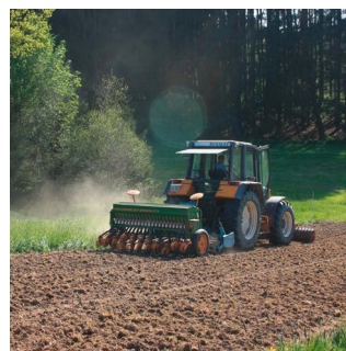
Die meisten Wildkräuter sind Lichtkeimer. Bei der Ansaat mit regionalen Wildpflanzen müssen die Säschare der Drillmaschine hochgebunden werden, damit das Saatgut nicht von Erde verschüttet wird. Foto: Sabine Heinz, LfL Bayern
