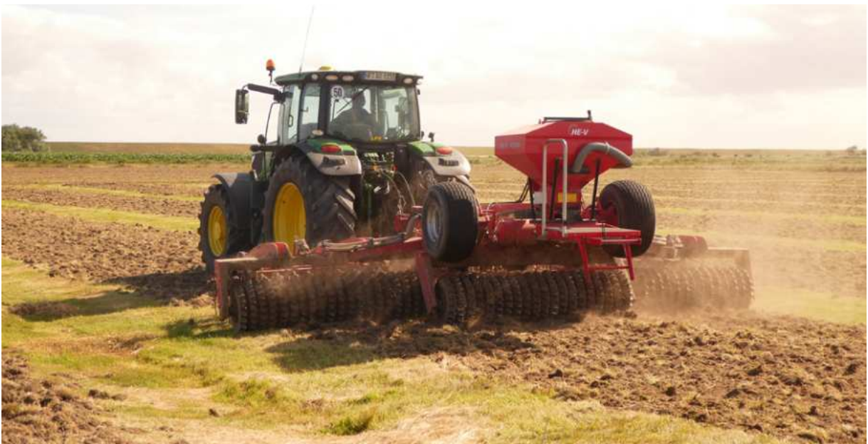
Abbildung 2: Auf den gefrästen Streifen auf der Wiese wird in einem Arbeitsgang das Regiosaatgut mit einer pneumatischen Sämaschine ausgebracht und mit einer Cambridge-Walze angewalzt. Foto: L. Unsel
